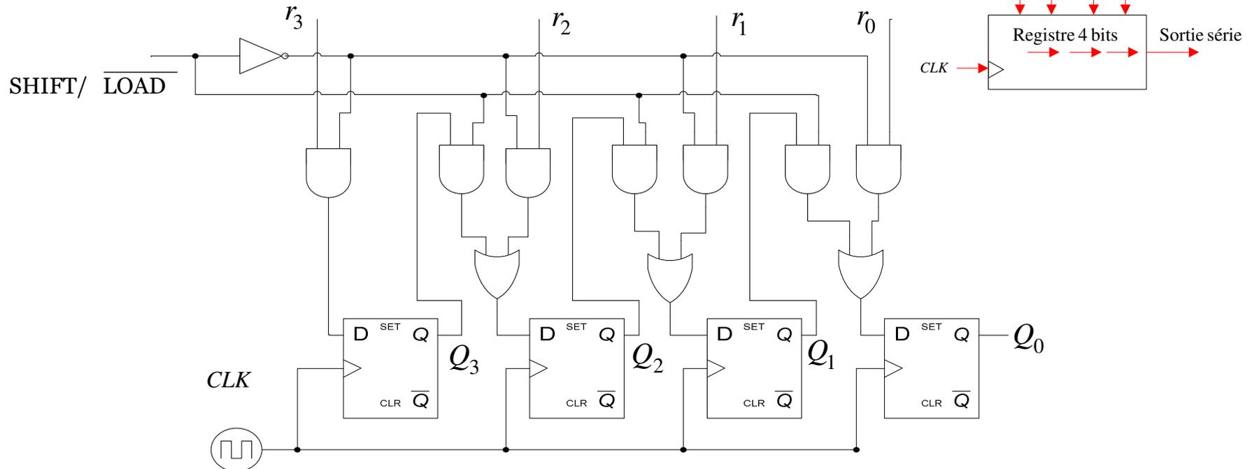
Si  $\text{SHIFT}/\overline{\text{LOAD}} = 0$ , les entrées ( $r_3, r_2, r_1, r_0$ ) sont introduites en même temps dans le registre. Les informations sont disponibles les unes après les autres au rythme de l'horloge.
