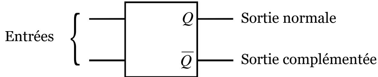
La sortie normal  $\underline{Q}$  détermine toujours l'état de la bascule. En pratique, la sortie complémentée  $\overline{Q}$  sert uniquement à simplifier le montage en évitant l'emploi des inverseurs.
