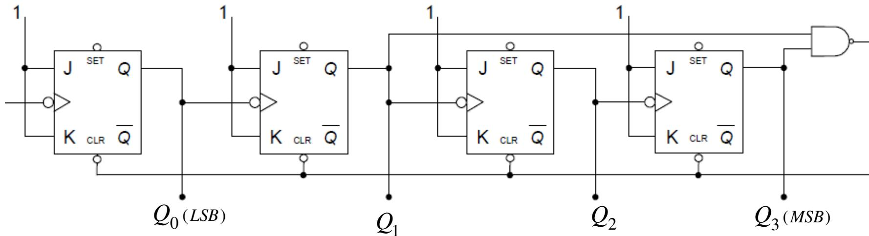
Réaliser ce montage sous ISIS à base du circuit intégrés de la famille : 74SL76 , 7400 et 7405 puis tester le montage.
