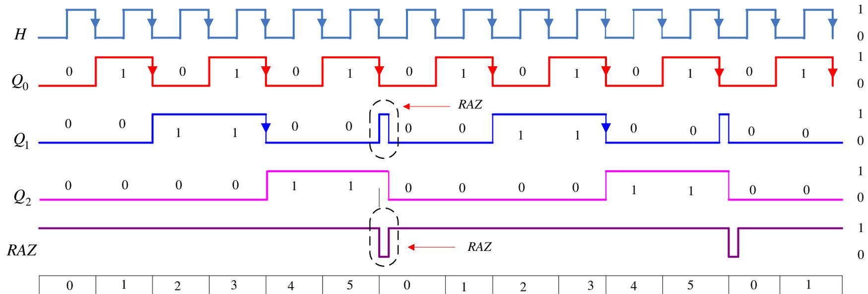
L'état intermédiaire  $(Q_2Q_1Q_0) = (110)_2$  apparaît pendant une durée très courte (quelques nanosecondes), car l'impulsion produite à la sortie de la porte logique NAND force le compte à  $(000)_2$ . C'est un état indésirable.
