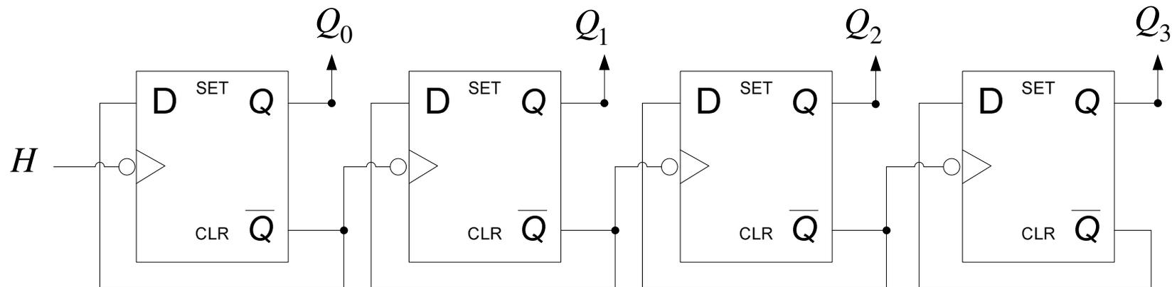
Réaliser ce montage sous ISIS à base du circuit 4013 puis tester le montage.
