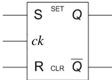
**Bascule RSH active sur niveau haut du signal d'horloge.**
