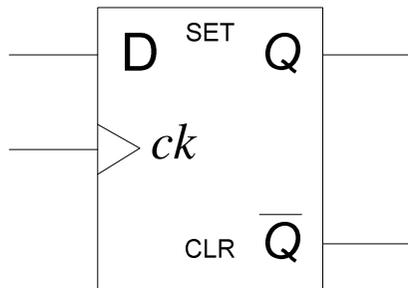
Bascule D synchronisée sur front montant
