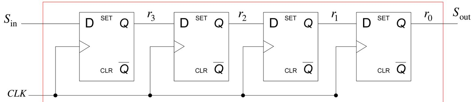
Ce registre possède une entrée série et une sortie Série. Les données binaires d'entrée sont introduites bit après bit. Elles sont également disponibles les unes après les autres au rythme de l'horloge en sortie. Ce type de registre est utilisé pour effectuer des décalages (registre à décalage à droite).
