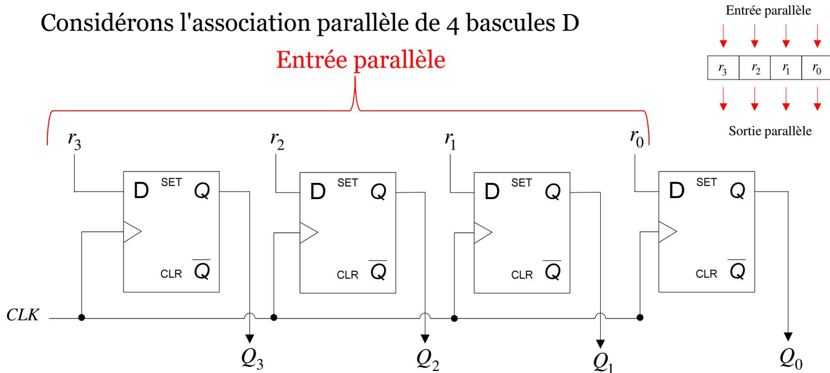
On obtient ici un registre de 4 bits, les 4 bascules sont chargées en parallèle par front montant du signal d'horloge. Les entrées véhiculent des informations de même nature : les lignes d'entrées constituent le BUS d'entrée. Les sorties  $Q$  constituent de même le bus de sortie
